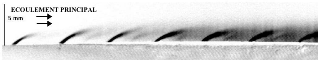
FIG. 2.4 - Image d'un film de refroidissement. Visualisation par fumée issue de la thèse de Rouvreau (2001) .
