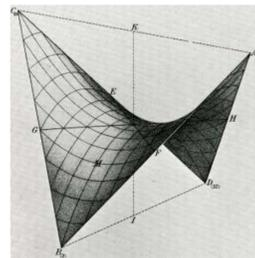
La figure ci-contre montre une surface minimisant l'aire pour un contour formé par quatre des arêtes d'un tétraèdre régulier. Schwarz a trouvé cette solution du problème de Plateau en 1865.
