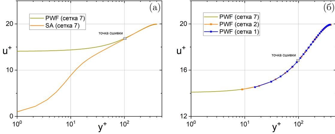
Рис. 3: Результаты расчетов с применением метода пенализированных пристеночных функций (PWF): а – сравнение с моделью Спаларта-Аламараса (SA) на разрешенной сетке, б – сравнение для сеток различного пристеночного разрешения.
