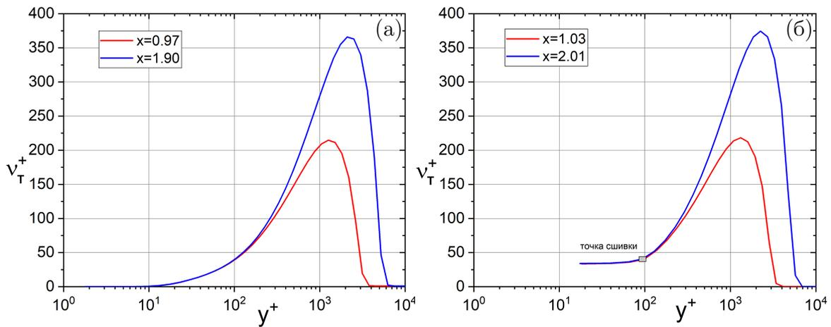
Рис. 8: Профиль относительной турбулентной вязкости  $\nu_T^+$ : а – модель Спаларта-Аламараса (сетка 1), б – метод пенализированных пристеночных функций (сетка 3).
