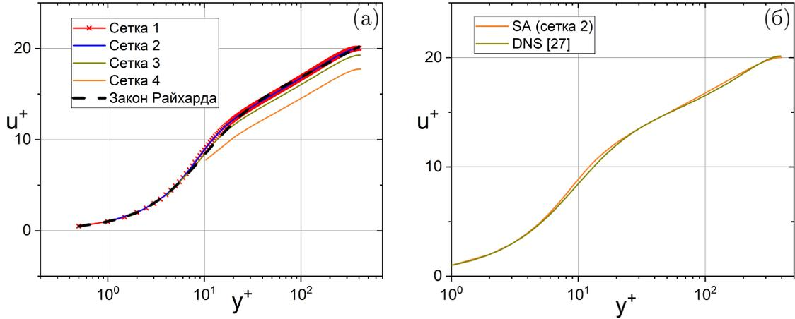
Рис. 2: Результаты расчетов с применением модели Спаларта-Аламараса (SA): а – сравнение с законом Рейхарда, б – сравнение с результатами прямого численного моделирования (DNS) [35].
