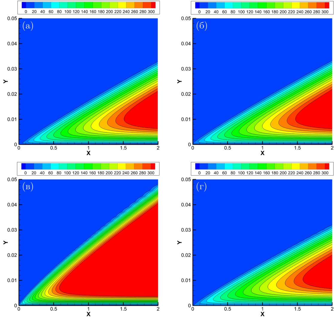
Рис. 6: Линии уровня относительной турбулентной вязкости ( $\nu_T/\nu$ ): а – код CFL3D, б – модель Спаларта-Аламараса (сетка 1), в – модель Спаларта-Аламараса (сетка 3), г – метод пенализированных пристеночных функций (сетка 3).
