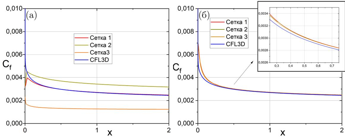
Рис. 5: Коэффициент поверхностного трения на плоской пластине: а – модель Спаларта-Аламараса, б – метод пенализированных пристеночных функций.
