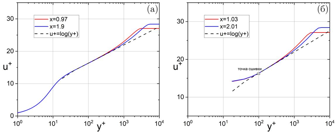
Рис. 7: Профиль продольной скорости: а – модель Спаларта-Аламараса (сетка 1), б – метод пенализированных пристеночных функций (сетка 3).
