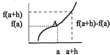
$f'(a) = \text{coef. dir. de la tangente en A à C}$
