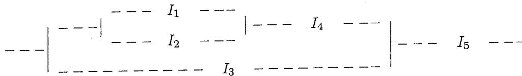
Au dysfonctionnement de chacun des éléments  $I_1, \dots, I_5$ , le courant dans cet élément ne passe plus. La probabilité pour  $I_k$ ,  $k = 1, \dots, 5$ , de tomber en panne pendant un an vaut  $p_k$ . On suppose que les pannes des différents éléments sont indépendantes. Trouver la probabilité de l'événement "le circuit laisse passer le courant pendant toute une année".
