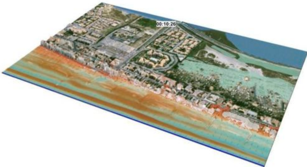
Figure 0.1: Exemple d'application du module Volume-Fini de WaveBox (anciennement SURF_WB), couplé à un modèle de houle à phase moyennée, effectuée dans le cadre du projet ANR MISEEVA (2009-2012): submersion de Palavas-les-Flots lors de la tempête de novembre 1982 ; Figure issue de [82].
