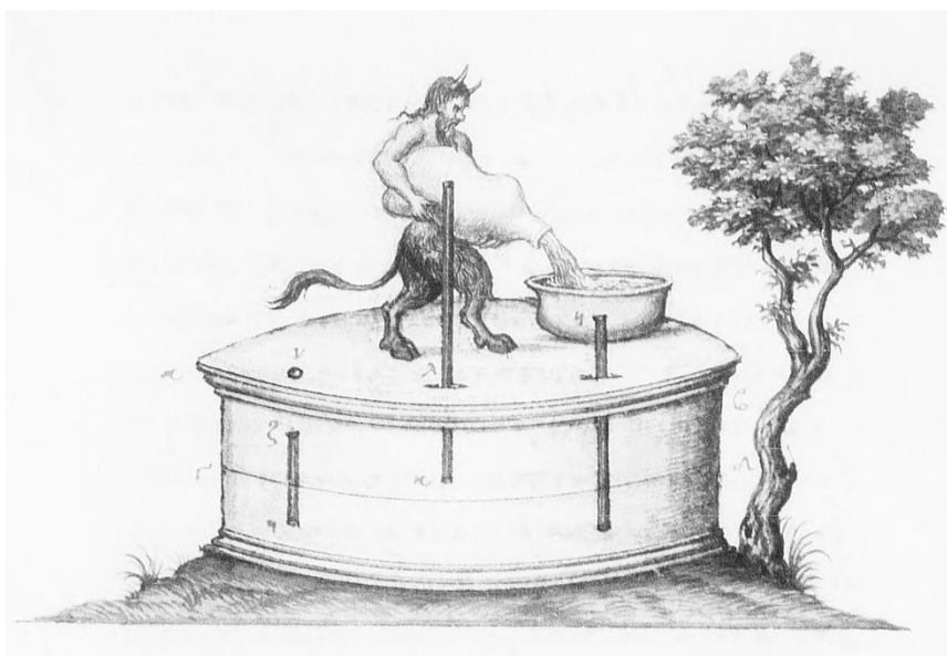
Figure 3b : Schéma de la fontaine surmontée d’une sculpture ornemental de satyre. Extrait du livre Pneumatica , copié par le moine Ange Vergèce au XVI e siècle :BNF – Gallica.
