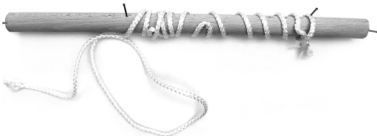
Figure 9 : En tirant sur la ficelle, on la déroule. La roue va tourner dans un sens, puis s'arrêter, puis reprendre son roulement, puis changer de sens, et enfin continuer de tourner jusqu'à la fin.
