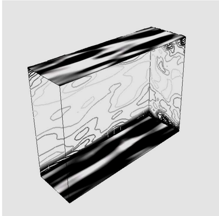
Fig. 1.5: Tenseurs de cisaillement au mur et isocontours de vitesse longitudinale pour le canal quasi isotherme
