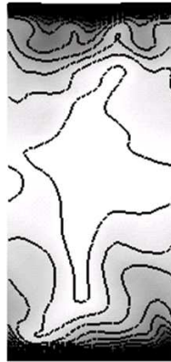
Fig. 1.24: Isocontours dans un plan (y, z) à x = L_x/2 du champ de température instantanée pour le canal anisotherme
