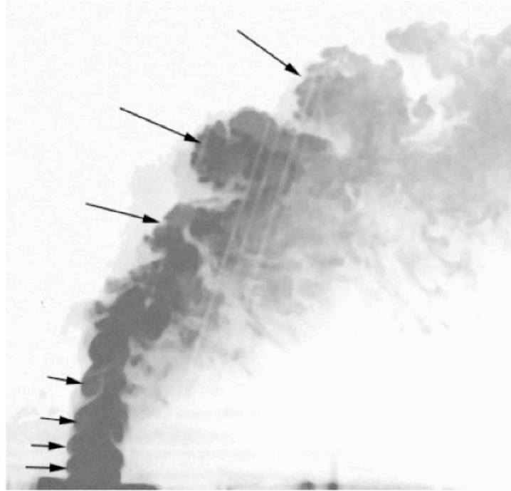
FIG. 1.3 - Jet transverse turbulent. Image obtenue par Rivero et al. (2001) par fluorescence induite par plan laser.
