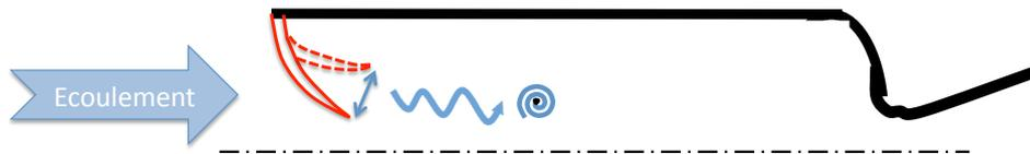
Figure 4.3 : Représentation schématisée du calcul de protection thermique battant dans un écoulement d'où proviennent Fig. 4.4 et Fig. 4.5
