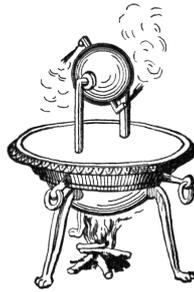
Figure 1.1 : Représentation de Eolipyle conçu par Héron d'Alexandrie
