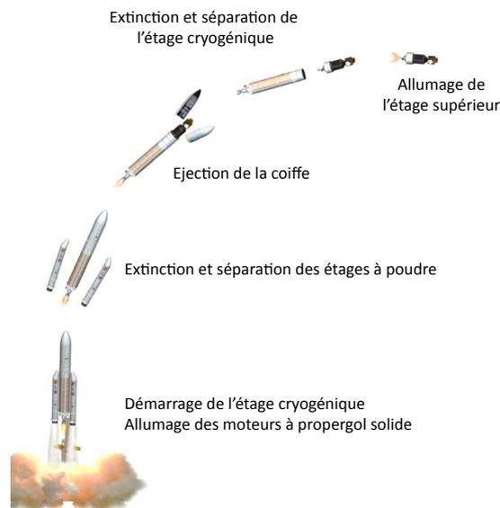
Figure 2 : *Séquence classique d'un tir Ariane 5 (source Ariane Espace : Ariane 5 User's Manual)*
