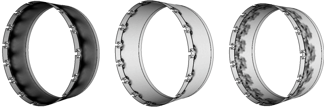
FIG. 5.18 - Le champ de vitesse du son (à gauche), et les coefficients n_u^{600}(\vec{x}) (au milieu) et \tau_u^{600}(\vec{x}) (à droite) sont copiés dans tous les secteurs.
